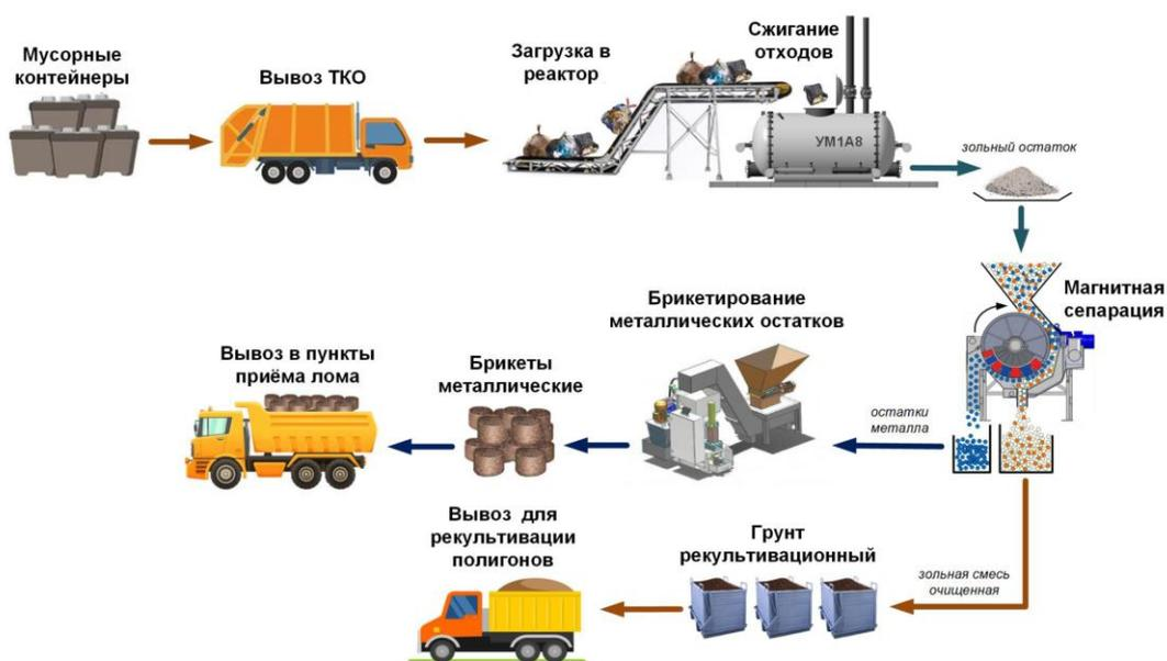
Рисунок 5.3 Обезвреживание отходов путем сжигания с использованием получаемого зольного остатка для восполнения дефицита рекультивационного грунта для полигонов
