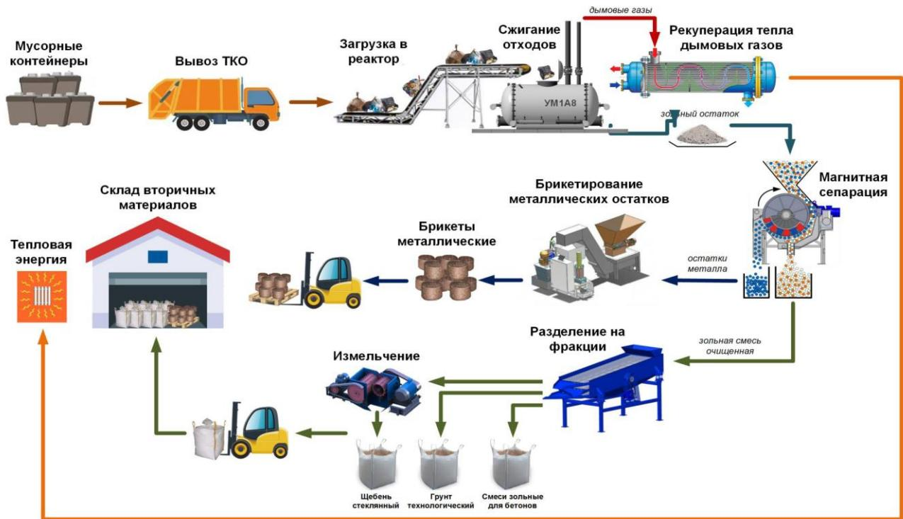
**Рисунок 5.2 Утилизация отходов путем сжигания с последующей переработкой получаемого зольного остатка и производством вторичных материалов**
